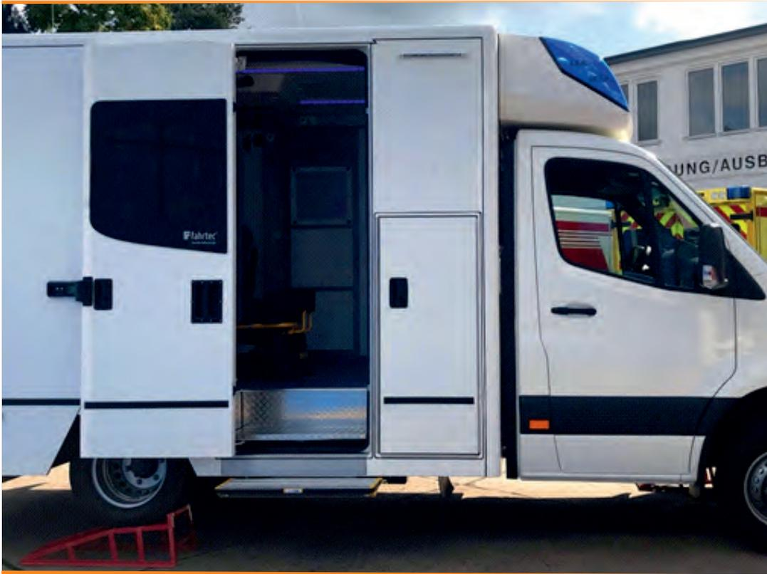
*Alle Türen und Klappen blieben trotz Verwindung voll funktionsfähig und ließen sich ohne erhöhten Kraftaufwand öffnen und schließen.*
