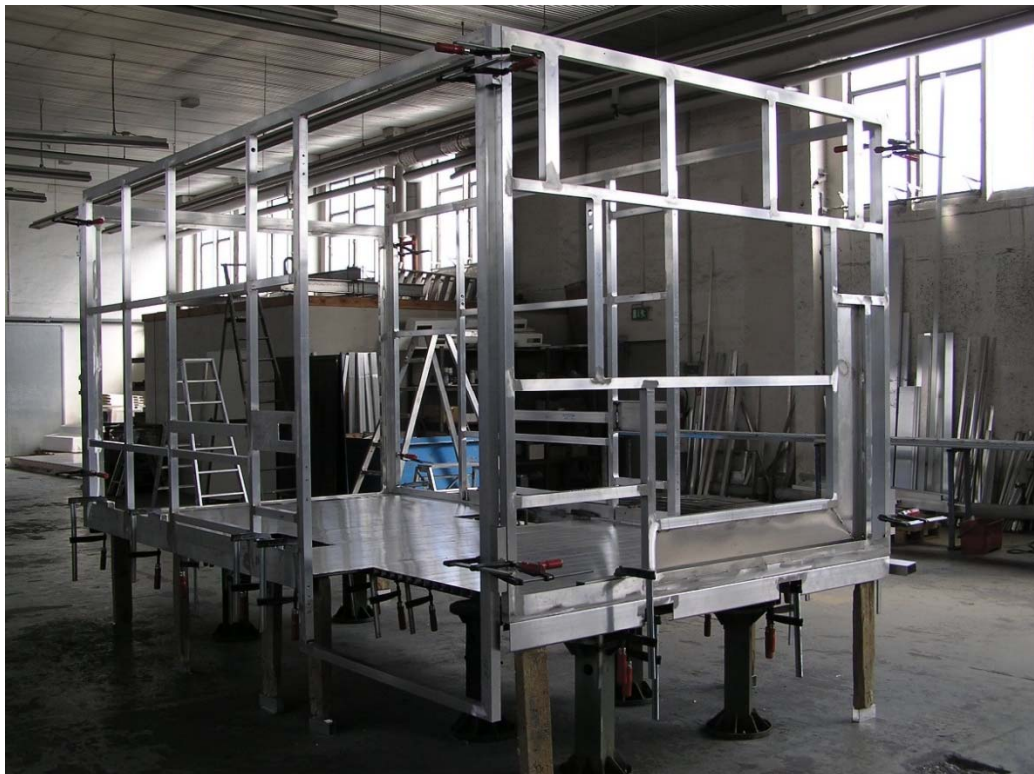
(Die typische Gerippe-Bauweise unseres Wechselkoffersystems)
